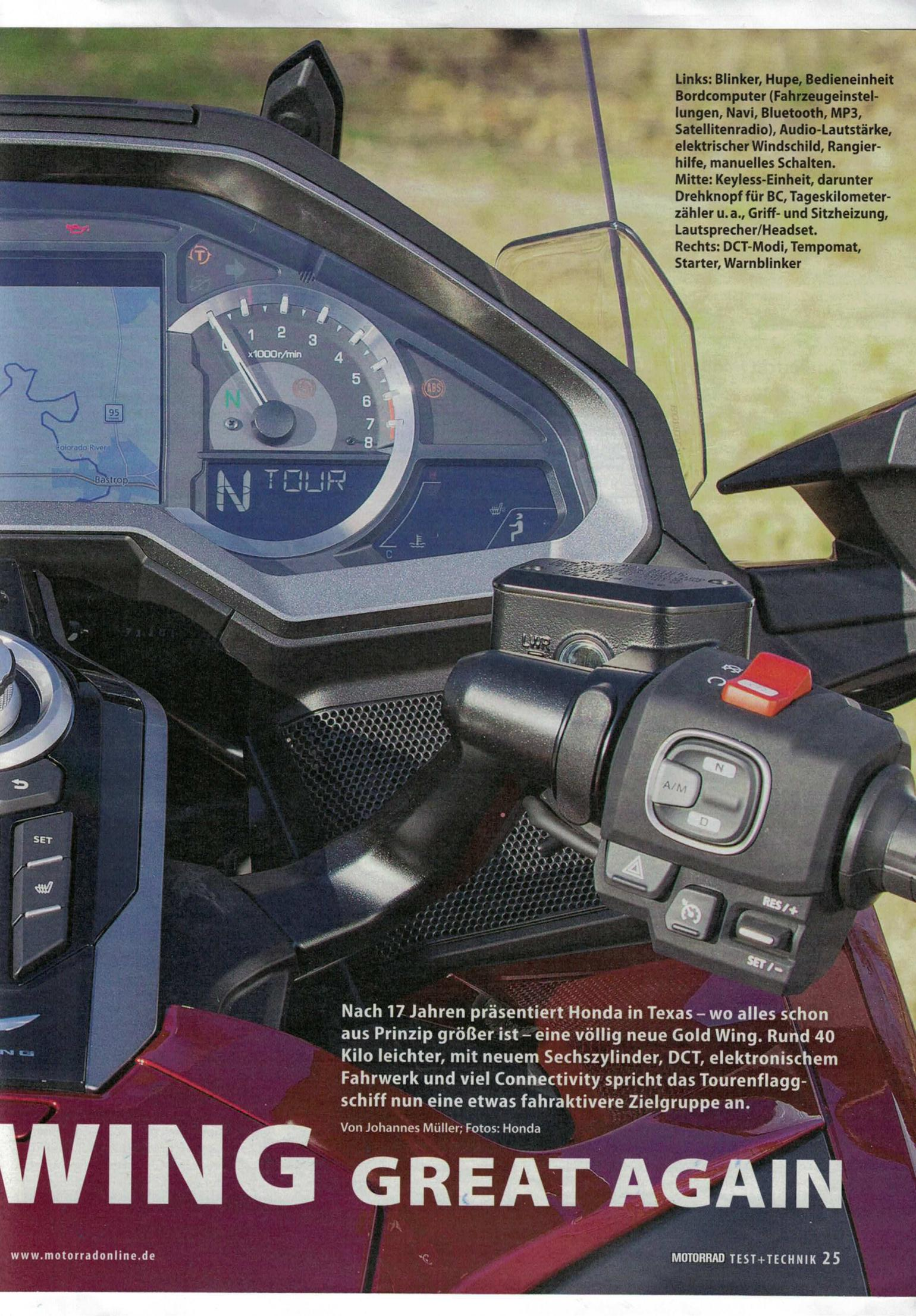
Links: Blinker, Hupe, Bedieneinheit Bordcomputer (Fahrzeugeinstellungen, Navi, Bluetooth, MP3, Satellitenradio), Audio-Lautstärke, elektrischer Windschild, Rangierhilfe, manuelles Schalten.
