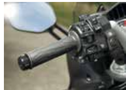
Ein Motorrad ohne Kupplungshebel: Bei der Yamaha FJR 1300 AS übernimmt die Elektrik diese Arbeit. Geschaltet wird mit Fuss oder Hand mittels Wippschalter an der linken Lenkerhälfte. Diese Hilfe ist aber keine Automatik und ist einmalig.
